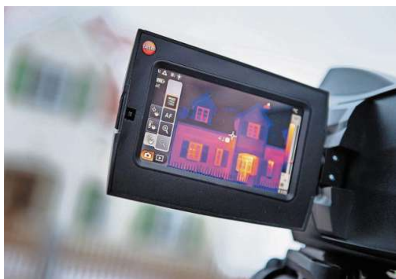
Dämmung spart Heizkosten: Beim Thermografie-Verfahren werden mit Wärmebildkameras die Oberflächentemperaturen der Wände erfasst. So lässt sich erkennen, an welchen Stellen Wärme verloren geht. FOTO: TOBIAS HASE/DPA
